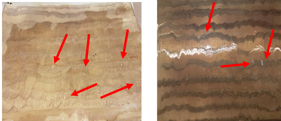
Figura 6. Puntos de mercurio identificados sobre las placas de cobre.
