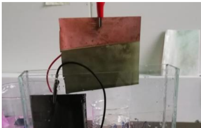
Figura 3. Plateado de placas de cobre con potencial de corriente eléctrica.
