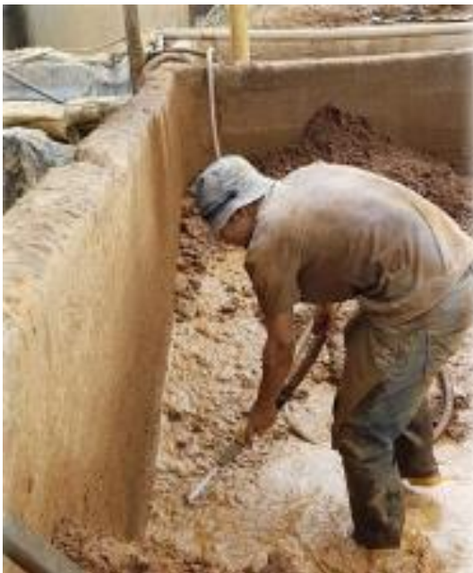
Figura 4. Alimentación de relaves Fuente: Pure Earth – 2020
