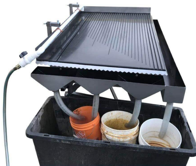
Figura 2. Mesa Vibratoria para concentración de relaves. Fuente: https://www.911metallurgist.com/metalurgia/mesa-concentradora-para-oro/
