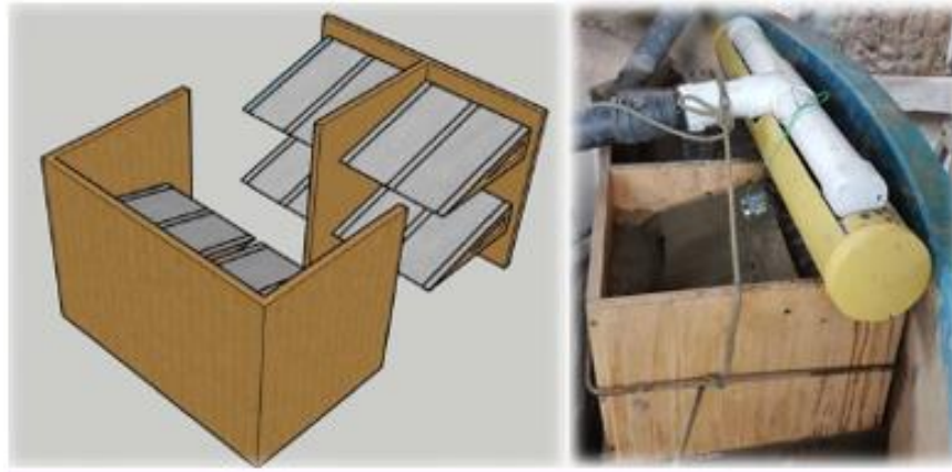
Figura 13. Módulo de soporte de las placas de cobre y circuito de distribución de flujo
