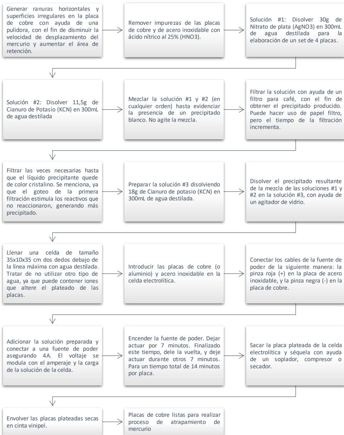
*Ilustración 3. Procedimiento para el plateado electroquímico de las placas de cobre.
